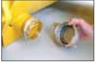
Un grande tapón de descarga permite una limpieza fácil de la tolva.
