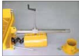
Una herramienta innovadora se encuentra entre los accesorios de su B100: la que permite sustituir un estator usado fácilmente y con toda seguridad.
