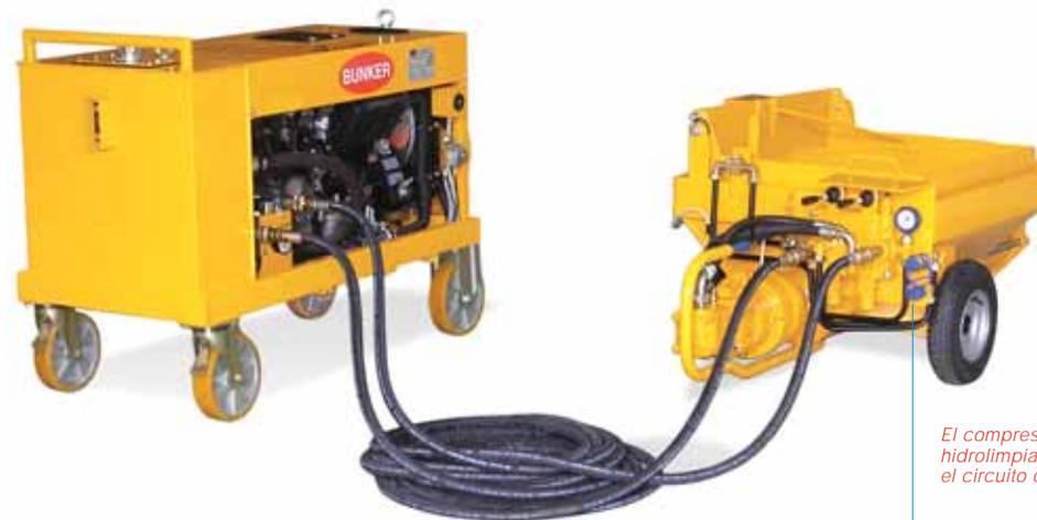
El compresor, la bomba dosificadora y la hidrolimpiadora funcionan directamente con el circuito oleodinámico de la B100.
