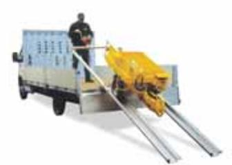
Para facilitar la utilización de la B100, Bunker ha inventado Fast 600, las rampas autocargadoras para la bomba y su centralita.
