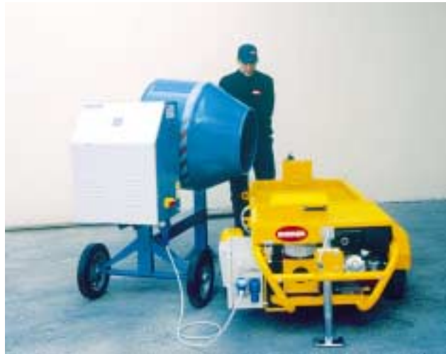
Hormigonera alimentada por la S8 SMART
