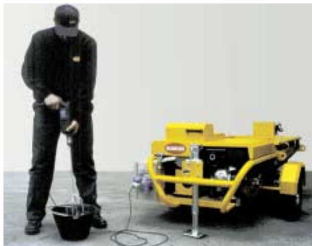
La S8 SMART mientras está alimentando un taladro para la preparación del mortero de acabado
