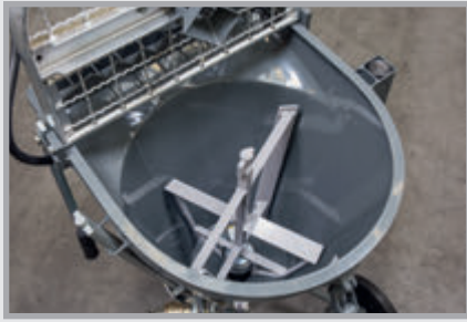
Mezcla bombeo y proyección de una tolva de material
