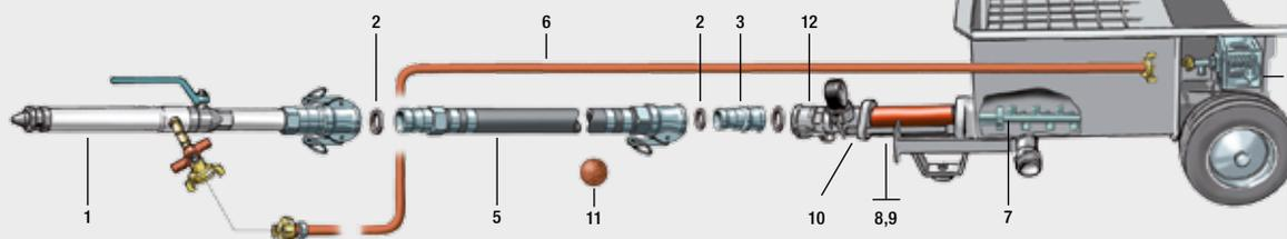
**Además se requiere un compresor con un caudal de aire de 400–500 l/min.**
