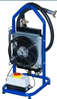
Sistema de refrigeración por aire para uso con una arenadora, permite secar el aire por enfriamiento. Evita las obstrucciones de arena en la boquilla de la arenadora. Durante el uso, deje siempre la válvula de drenaje inferior ligeramente abierta para permitir que salga el agua.
