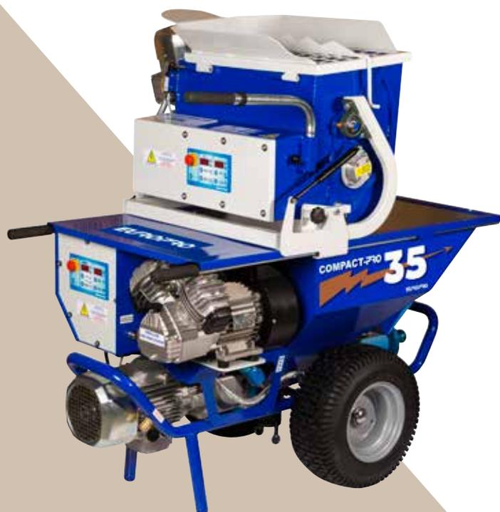
Conjuntos compuesto de una máquina de proyección y un mezclador en continuo. La máquina esta equipada de un vibrador en la cuba para un mejor descenso del producto hacia el fondo. El mezclador está equipado con una doble hélice helicoidal sobre un eje horizontal para garantizar una mezcla rápida y homogénea, un dosificador de agua, un variador de velocidad y una función de selección de marcha hacia adelante/atrás.
