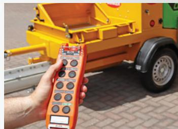
Il radiocomando permette di avviare e arrestare a distanza la pompa a vite, di regolare la sua portata rispettivamente al 30%, 60% e al 100% (Max) della portata massima, invertire il suo senso di rotazione per scaricare la pressione dalla tubazione in caso di intasamenti. Un **indicatore Led** sul trasmettitore del radiocomando segnala l'apertura della griglia di protezione
