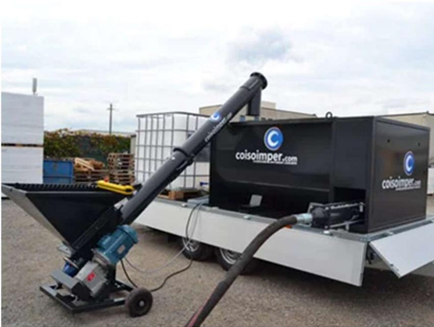
**CTC v2 v2** con longitud de 2,6 a 3,5 m (usado con mezclador colocado sobre remolque o camión). Desmontable en dos piezas para facilitar su transporte.
